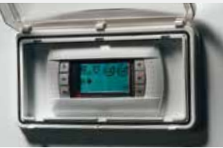
Semi-graphic backlit PGD terminal.
